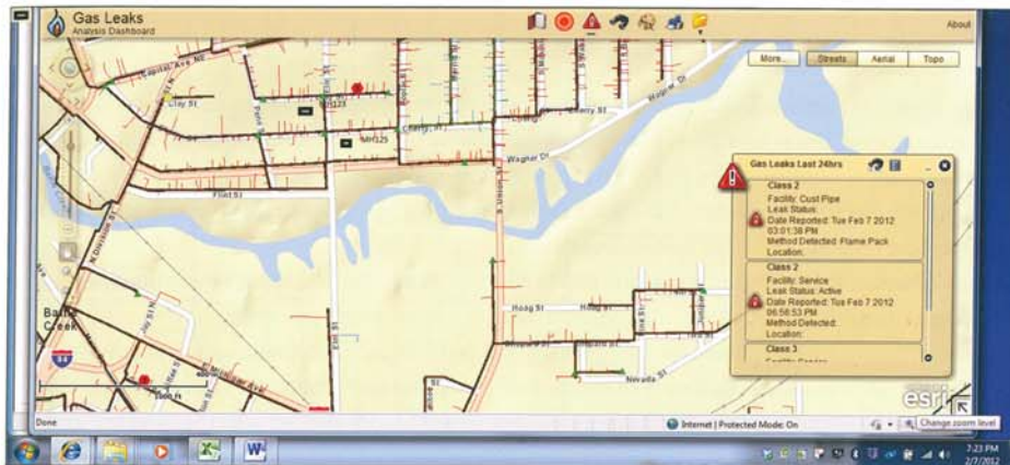
شکل ۱۰-۷- به کمک GIS، می‌توان منهول‌هایی را که در نزدیکی آن‌ها نشستی گاز وجود دارد، شناسایی کرد. (منبع: Esri)
