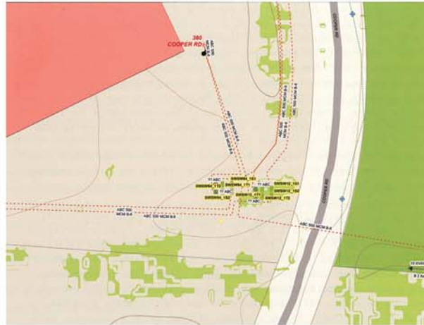
شکل ۸-۴- نمایش شبکه کابلی فشار ضعیف بر روی نقشه‌های GIS
