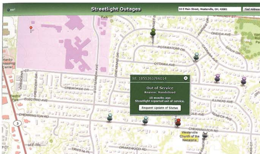
شکل ۱-۴- استفاده از محیط وب GIS جهت نمایش و گزارش خاموشی شبکه روشنایی معابر (منبع: شهرداری Westerville ایالت Ohio)
