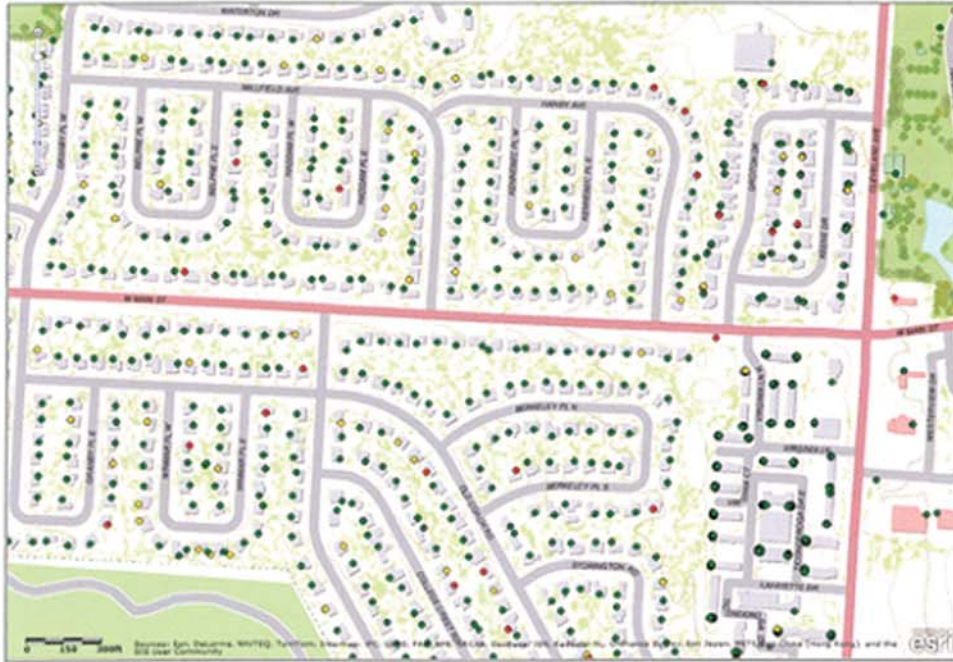
شکل ۱۱-۲- نمایش موقعیت کنتورهای هوشمند با توجه به میزان مصرف بر روی نقشه‌های Web GIS (منبع: شهرداری شهر Westerville ایالت Ohio)
