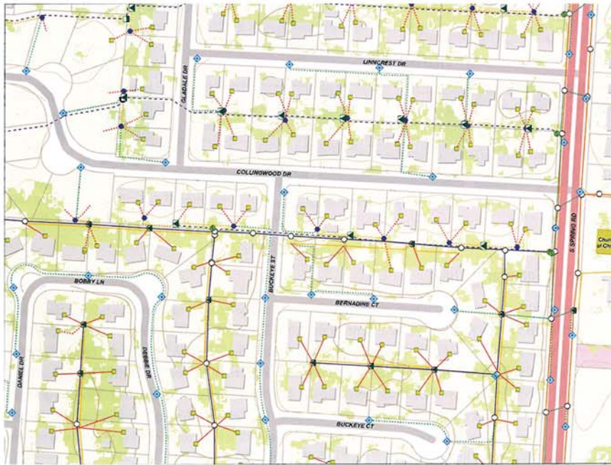
شکل ۲-۳- نمایش شبکه هوایی (خطوط پیوسته) و شبکه زمینی (خطوط نقطه چین) بر روی سیستم GIS (منبع: شهرداری شهر Westerville در ایالت Ohio)
