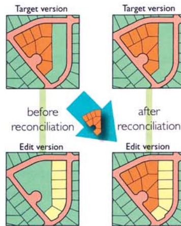
شکل ۴-۴- مراحل اجرای فرآیند مغایرت‌گیری در ابزار ورژنینگ
